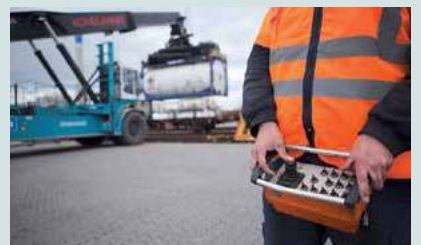
Пульт радиоуправления для погрузочно-разгрузочных работ на железнодорожном и морском транспорте
